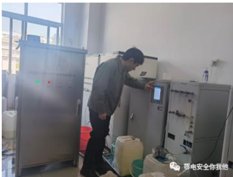
图 2 油色谱在线监测装置到货验收
